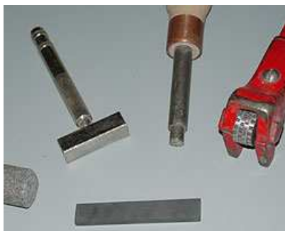
Les redresse-meule sont essentiels pour l'affûtage. Exemples de gauche à droite: bâton redresseur gris, diamant en T, diamant rond, roulette-étoile et, au premier plan un bâton de carbure de bore.
